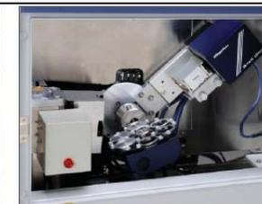
Комбинация 1Д высокоскоростного детектора и устройства для автоматической смены образцов обеспечивает высокую производительность в ходе работы.
